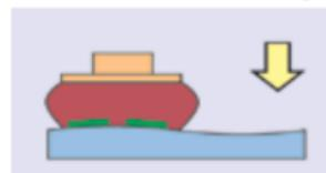
In einer Abrollbewegung wird der Tampon auf den Bedruckstoff gepresst.
