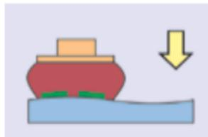
Dans un mouvement de nutation, le tampon est pressé sur le support d'impression.
