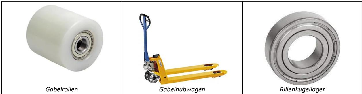
Die Rollen bestehen aus Polyamid und haben einen Aussendurchmesser von 80 mm. Im inneren haben sie zwei Rillenkugellager 55 x 30 x 13 mm. Diese werden an einem Handarbeitsplatz mittels einer Kniehebelpresse mit einer Druckkraft von 100 N eingepresst.
